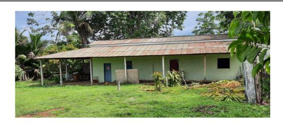
1. Uma casa residencial, tipo avarandada, destinada ao caseiro, de conservação ruim, integralmente feita em concreto, coberta de telhas brasilit tipo ondinha, possuindo aproximadamente seis cômodos, sem forração, com instalação elétrica e hidráulica, com piso de cimento queimado, exceto no banheiro de um dos cômodos que é na cerâmica. Avaliada em R\$ 38.000,00 (trinta e oito mil reais).
